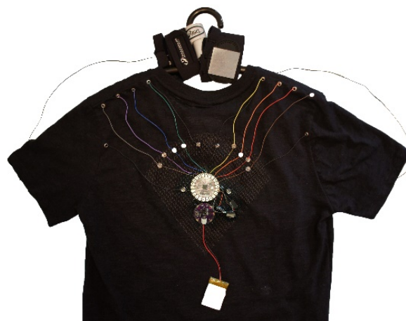
Costas da camisa: O som que deve ser emitido ao fechar o contato em cada placa é controlado por um Lilypad-Arduino.
